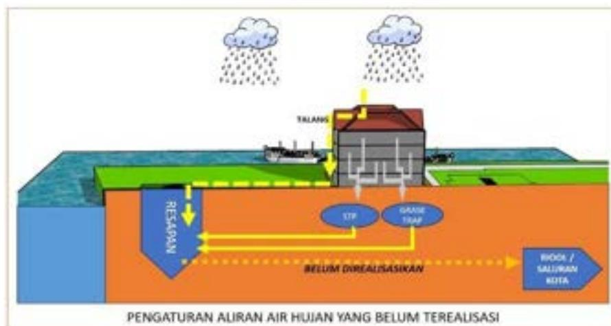
**Gambar 8. Skema Saluran Air Kotor dan yang riol kota yang tidak terhubung dengan saluran lingkungan Kampung Aquarium**
