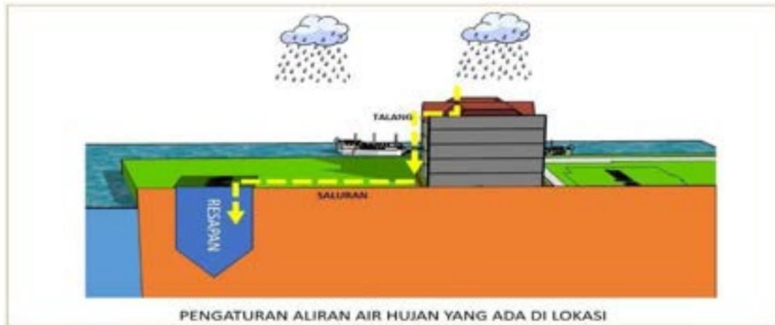
Gambar 5 Skema Saluran Air Hujan yang Terjadi
